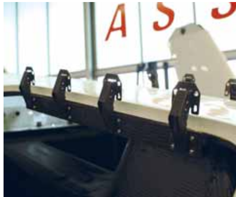
De deuren in de neus van de DA-42 Twin Star hadden oorspronkelijk twee scharnieren. Het werden er uiteindelijk vier met het oog op een grotere stijfheid van de neus.
