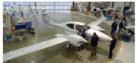
Om het werken aan de vliegtuigen vlak voor aflevering te vereenvoudigen, wordt gebruik gemaakt van een draaischijf. Scheelt ruimte en is uitermate efficiënt. Hier wordt de PH-DTS aan een laatste afleveringsinspectie onderworpen.
