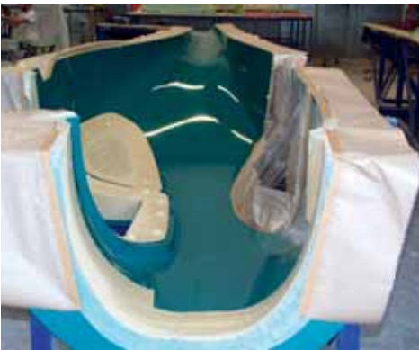
De laminaatlagen zijn aangebracht, de romp is klaar om de oven in te gaan. In dit stadium van het productieproces wordt in tweeploegendienst gewerkt. Ploeg 1 lamineert, en ploeg 2 ruimt op en maakt de mallen klaar voor ploeg 1. (Foto: Diamond Aircraft)
